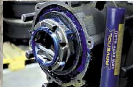
Подшипник ступицы колес MAN
