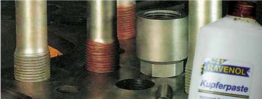
Болты обшивки турбин на электростанции
