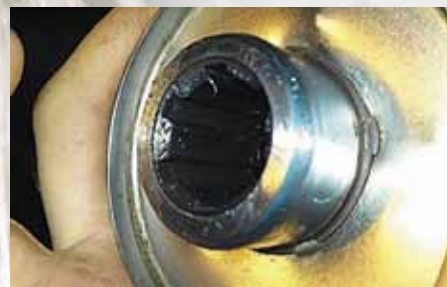
Рабочая поверхность сальника фланца и его шлицы
